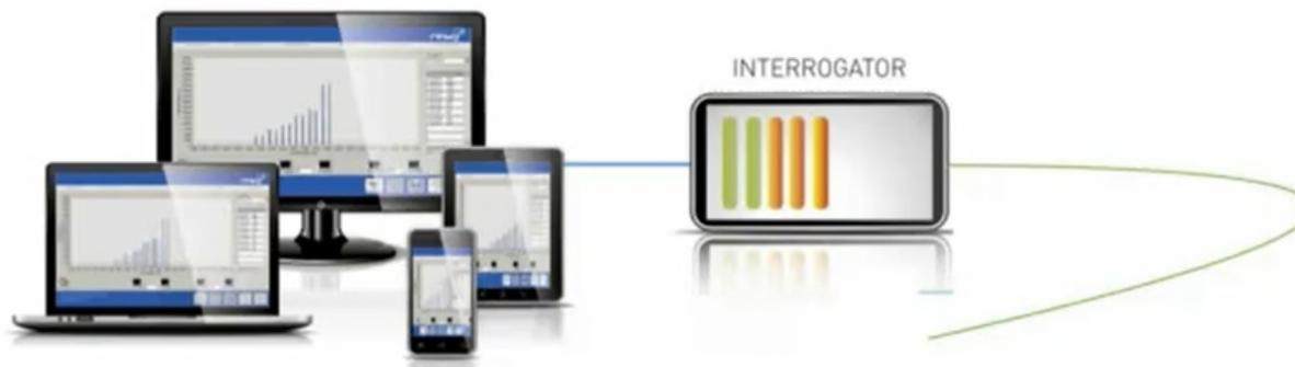
La tecnologia a «**Fibra Distribuita**» utilizza sensori che sfruttano il fenomeno conosciuto come **Stimulated Brillouin Scattering (SBS)**, processo di diffusione anelastica di radiazione elettromagnetica visibile, per misurare le variazioni di strain o temperatura.
