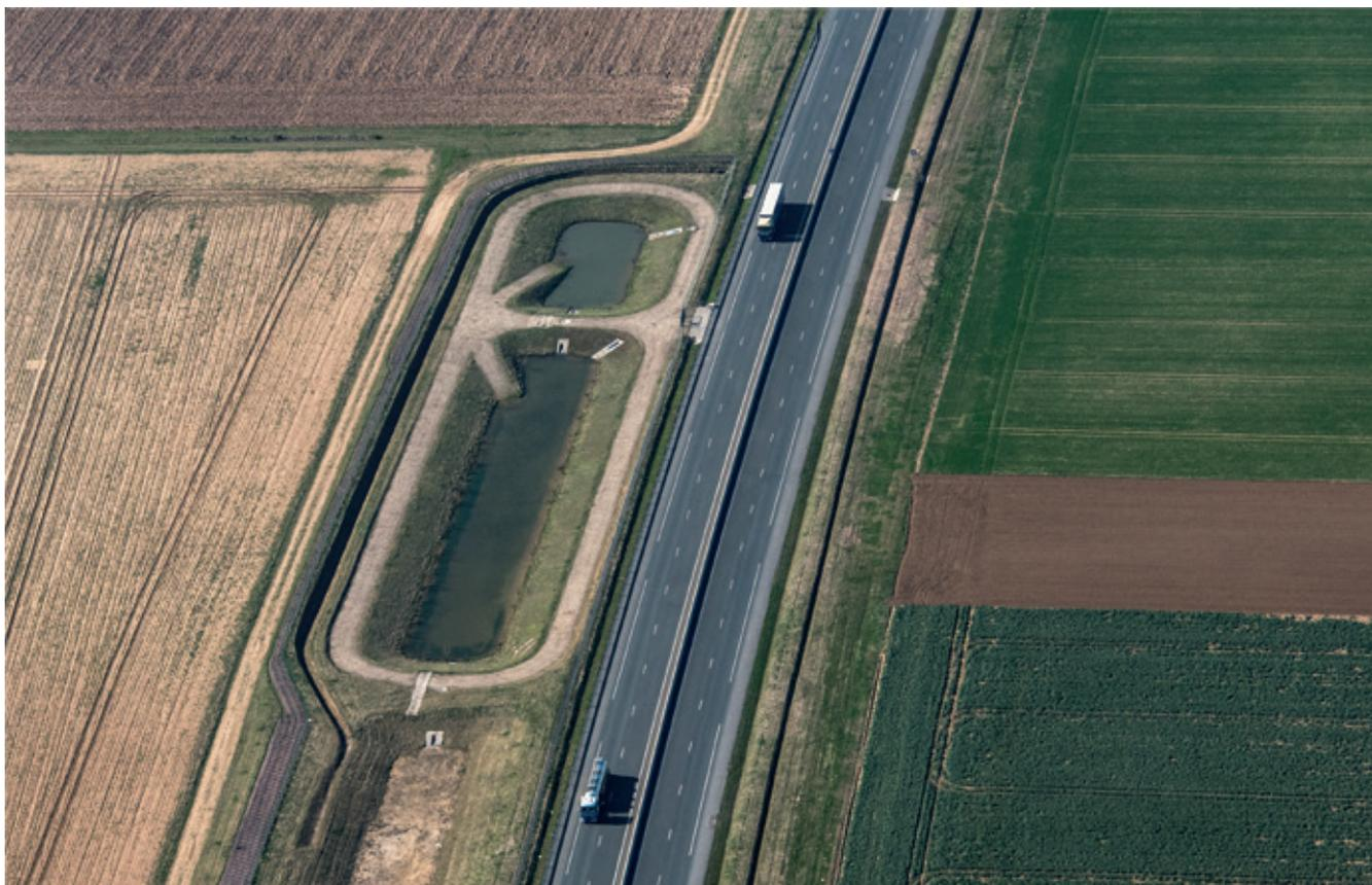
Figura 47. Esempio di bacino di accumulo presso il dipartimento Eure-et-Loir a ovest di Parigi.
